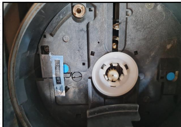
Fotografias 18 e 19: Detalhes dos selos externo, do Inmetro, no tacógrafo, que se encontrava rompido e do interno (de aferição) que se encontrava intacto, respectivamente.
