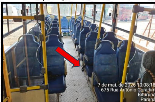
Fotografia 28: Detalhe dos bancos de passageiros e dos cintos de segurança.
