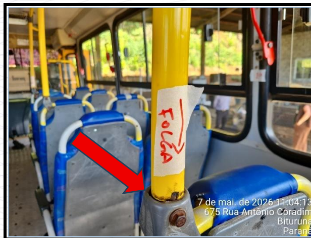
Fotografias 24 a 27: Detalhes dos balaústres que apresentavam pequenas folgas de fixação.
