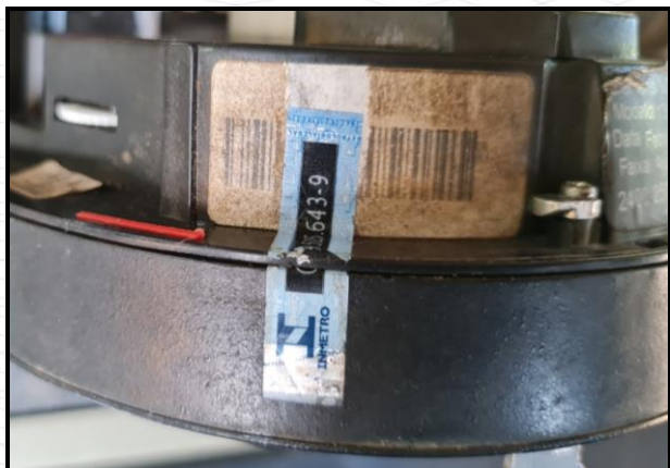
Fotografias 18 e 19: Detalhes dos selos externo, do Inmetro, no tacógrafo, que se encontrava rompido e do interno (de aferição) que se encontrava intacto, respectivamente.
